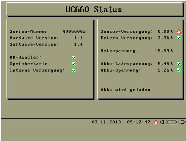
Die OK-Zeichen zeigen an, dass alles in Ordnung ist, das Gerät ist einsatzbereit. Achtung-Zeichen zeigen Fehler an, die einwandfreie Funktion des Gerätes ist dann nicht mehr gewährleistet. Dieses Beispiel zeigt den Ausfall der Sensorversorgung, mehr Informationen dazu finden Sie im Kapitel „Fehlermeldungen“.
