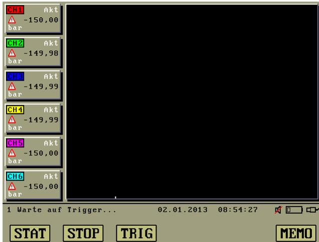
Das Gerät wartet nun auf die eingestellten Trigger-Voraussetzungen. Während dessen wird ein Trigger-Vorlauf bis maximal 10% der Gesamtzeit aufgezeichnet. Dieser Modus kann NUR mit
