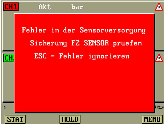
Dieser Fehler tritt auf, wenn durch ein defektes Messkabel ein Kurzschluss verursacht wurde. Sie können diesen Fehler beheben, indem Sie das Messkabel austauschen, und die Sicherung „F2 SENSOR“ am oberen linken Rand des Gerätes ersetzen. Dann blendet die Meldung automatisch wieder aus.
